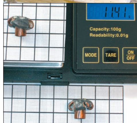
Kuva käytetystä märkien sanomalehtien pinkasta osumien jälkeen, sekä talteen saadut Rhino-luodit osuttuaan kahden metrin päässä olleeseen paperipinkkaan. Rhino-luotien halkaisijat / jäämäpainot ovat 19 mm / 11,41 g ja 18 mm / 10,39 g. Alempana kuvassa näkyvästä luodista irtosi yksi siipi.
