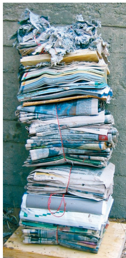
Rhino- ja Sako SHH-luotien haavakanavien muodot syvyyden funktiona (yläkuva) ja luotitestissä käytetty puhelinluetteloniippu (alakuva).
